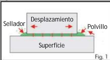
La grasa forma un collar de sellado contra la humedad y las partículas de suciedad entre las partes aplicadas. La suciedad no puede alcanzar el punto lubricado, asegurando la misma por un largo tiempo. De esta forma se extiende el tiempo entre lubricaciones. Las futuras lubricaciones deben realizarse únicamente limpiando la zona.
