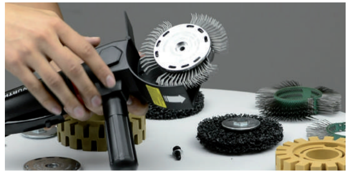
Paso 4: Colocar del lado hexagonal el adaptador en la ranura de la cepilladora.
