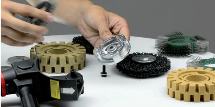
Paso 1: Seleccionar el abrasivo de trabajo, y su correspondiente adaptador ( ver tabla).
