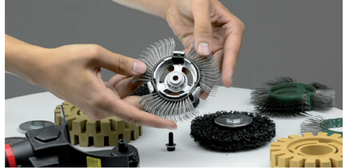
Paso 2: Colocar la herramienta de trabajo dentro del adaptador.
