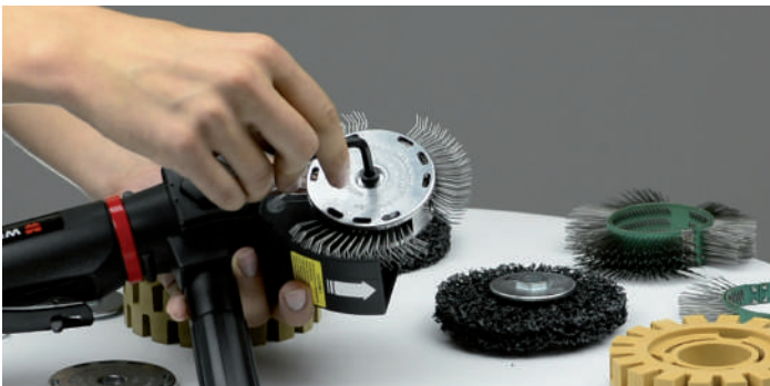
Paso 5: Con la llave allen y el tornillo correspondiente ajustar el adaptador a la cepilladora (en marcha la herramienta trabaja suavemente).
