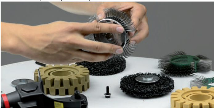
Paso 3: Cerrar el adaptador con la tapa correspondiente.
