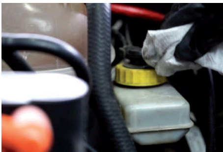
Limpe la tapa del reservorio.
