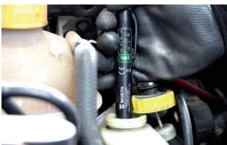
Sumerja el tester en el líquido de freno hasta el borde del plástico del dispositivo.
