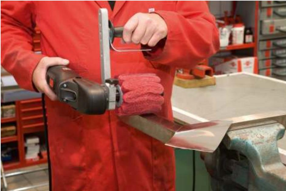
Rollo para acabado de vellón plisado para trabajo sin esfuerzo. Encastre de 6mm. cónico y orificio de 19mm. para máquinas de lijar superficies y máquinas de pulir con mandril de sujeción.
