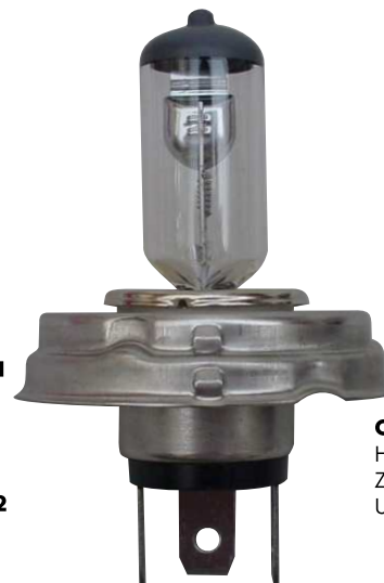
Cód. 80720 110 1 H4, 12V 60/55W Zócalo: P 43t Uso: alta y baja
