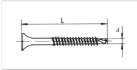
**Tornillo con encastre PH2 con punta auto-perforante para construcción rápida.**
